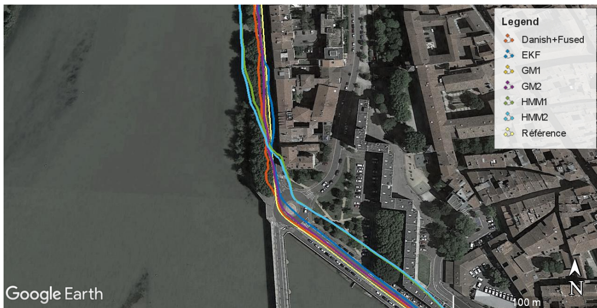
FIGURE 4.20 – Illustration des différentes trajectoires obtenues pour la méthode parcimonieuse et les méthodes à base de mélanges de Gaussiennes.
